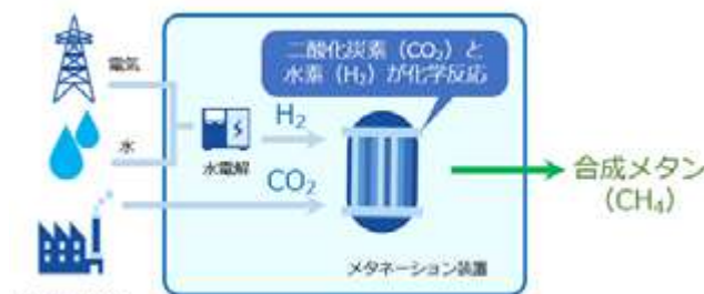
CO 2 分離・回収 メタネーションの合成フロー
